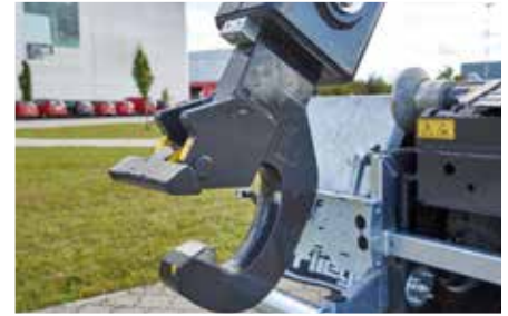
Geschmiedeter, einfach auswechselbarer Aufnahmehaken
